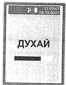
Ако въздушната проба е достатъчна (достигнати са минималния обем въздух и минималния период на вдихване), започва вземането на проба. Когато зеленият светодиод изгасне, звуковият сигнал престава.
