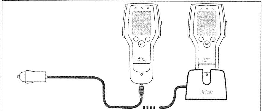
За зареждане в автомобил се препоръчват зарядно за автомобил 600 mA (част № 83 20 252) и опционално гнездо за зареждане.
