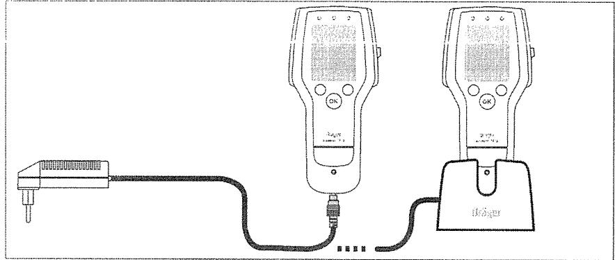
За зареждане в електрическата мрежа се препоръчват Адаптер 220 V/ 600 mA (част № 83 16 991) и опционално гнездо за зареждане.
